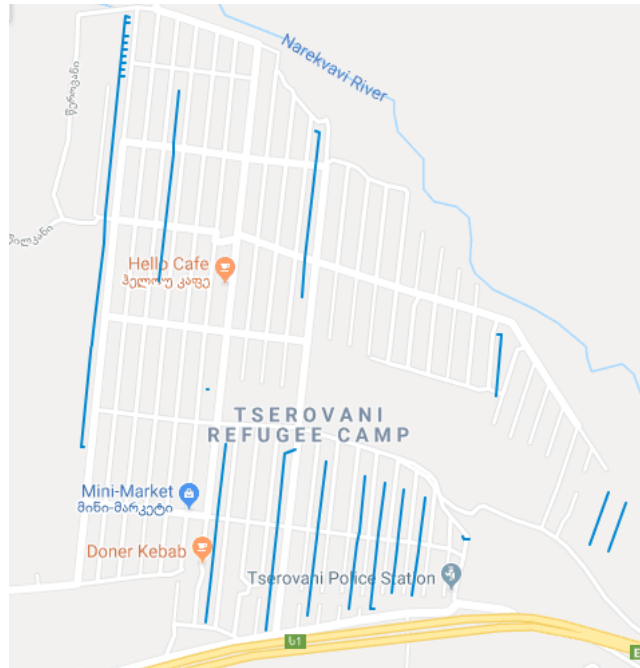
გამოსახულება 2: წეროვანის ლტოლვილთა დასახლების წყალმომარაგების სისტემა (მხოლოდ რამდენიმე მილსადენია ნაჩვენები)
